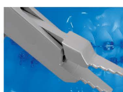
DO.688.300 Nance Loop forming pliers Four steps beak for making precision loops of 3,4,5 or 6mm in round or rectangular wires. One tip is serrated to prevent wire slippage Kleszcze do formowania pętli Czterostopniowe dzioby dokładnie formują pętlę 3, 4, 5 i 6 mm na łukach okrągłych lub prostokątnych. Jedna końcówka jest żłobiona aby zapobiec wyslizgiwaniu się łuku.
