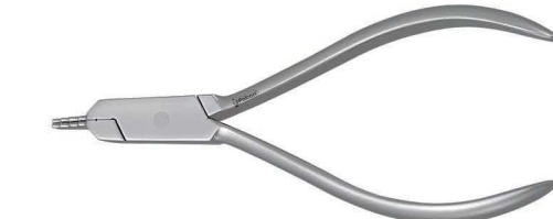
DO.688.300 Nance Loop forming pliers Four steps beak for making precision loops of 3,4,5 or 6mm in round or rectangular wires. One tip is serrated to prevent wire slippage Kleszcze do formowania pętli Czterostopniowe dzioby dokładnie formują pętlę 3, 4, 5 i 6 mm na łukach okrągłych lub prostokątnych. Jedna końcówka jest żłobiona aby zapobiec wyslizgiwaniu się łuku.
